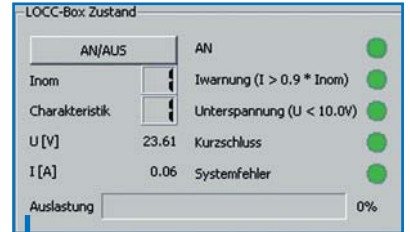
Zeigt den Betriebszustand, Strombereich / Charakteristik, die Auslastung der Kennlinie sowie die momentanen Werte von Strom und Spannung an
